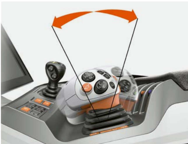
Progressiv betjening med trinløs CMATIC-gearkaseteknologi.
