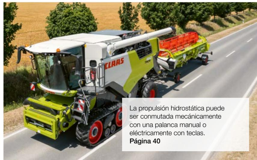
La propulsión hidrostática puede ser conmutada mecánicamente con una palanca manual o eléctricamente con teclas.
