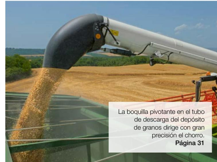
La boquilla pivotante en el tubo de descarga del depósito de granos dirige con gran precisión el chorro.
