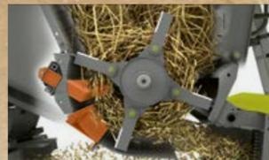
Broyeur SPECIAL CUT avec contre-couteau et fond rotor à élément escamotable.
