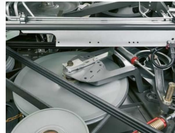
Profondeur de piquage des doigts dans le matelas de paille réglable.
