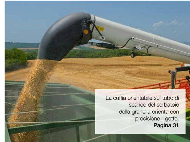
La cuffia orientabile sul tubo di scarico del serbatoio della granella orienta con precisione il getto.
