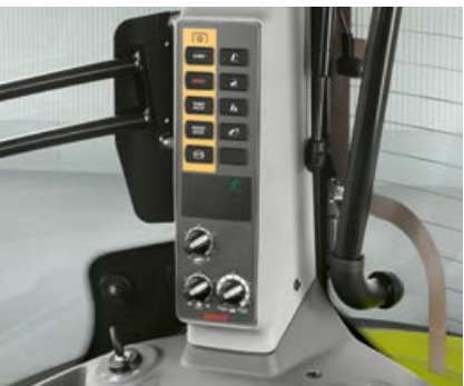
GTV sūkius ir elektroninio galinės pakabos valdymo sistemą galima reguliuoti valdikliais B statramstye
