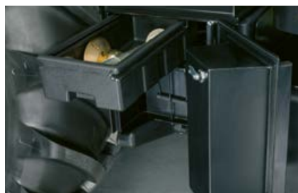
Baterija ir įrankių dėžė įrengtos lengvai pasiekiamoje vietoje, traktoriaus dešinėje, šalia laiptelių.
