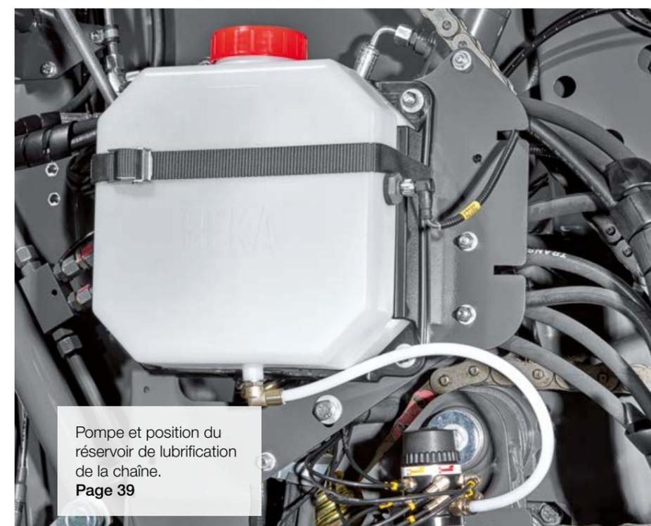
Pompe et position du réservoir de lubrification de la chaîne.
