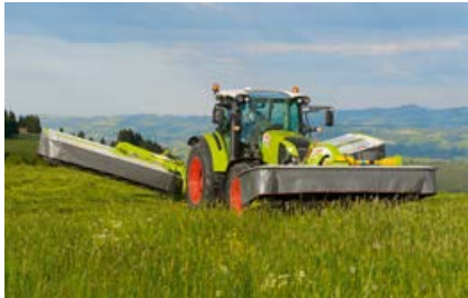
La suspension compacte du relevage avant confère à la faucheuse une garde au sol élevée en fourrière.
