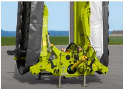
Gain de place : position de remisage stable pour les faucheuses grande largeur
