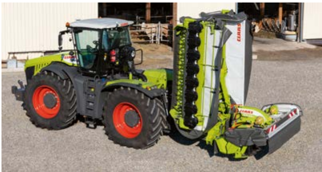
Gabarit compact en position de transport
