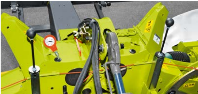
Manomètre pour un réglage aisé de la pression d'appui des deux unités de fauche
