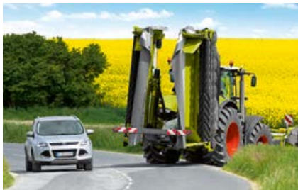
Moins de 4 m de hauteur : encombrement réduit en position de transport, avec une garde au sol généreuse sur les deux modèles BUSINESS
