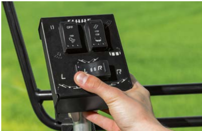
Console de commande pratique pour le relevage individuel, le repliage en position de transport et l'activation/désactivation des phares de travail (option) disponible pour la DISCO 1100 TREND
