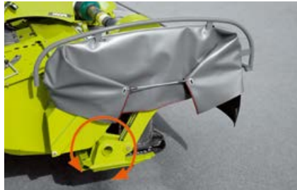
Grâce à l'articulation en pied de lamier, la faucheuse DISCO PROFIL suit le sol et non le tracteur.
