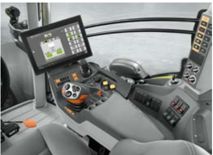
Commande par présélection du CONTOUR possible sur terminal compatible ISOBUS si le tracteur en est équipé
