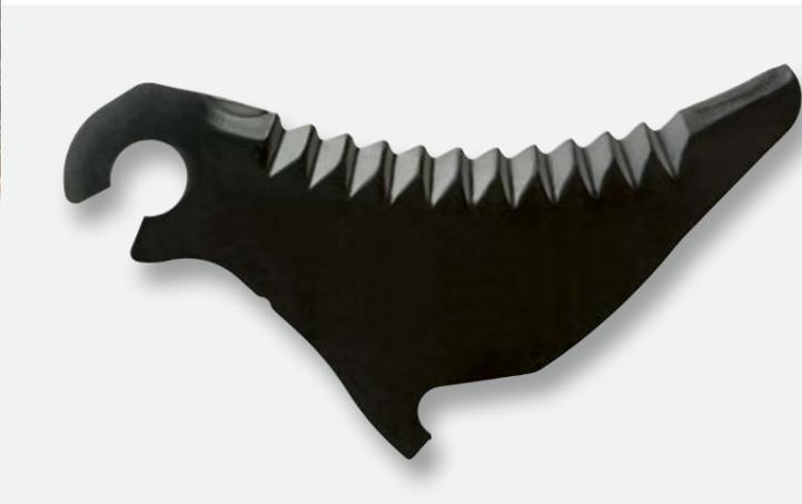
Zum Schnitt: Der massive Heavy-Duty-Schneidrotor der ROLLANT ist für Höchstleistungen ausgelegt. Er besteht aus doppelt gehärtetem Borstahl mit spiralförmig angeordneten Doppelzinken. Die Einzelmessersicherung bewahrt die Messer vor Schäden, erhöht damit ihre Lebensdauer und sorgt für eine gleichbleibende Schnittqualität. Die Messer sind auch mit Wolframcarbidbeschichtung erhältlich.
