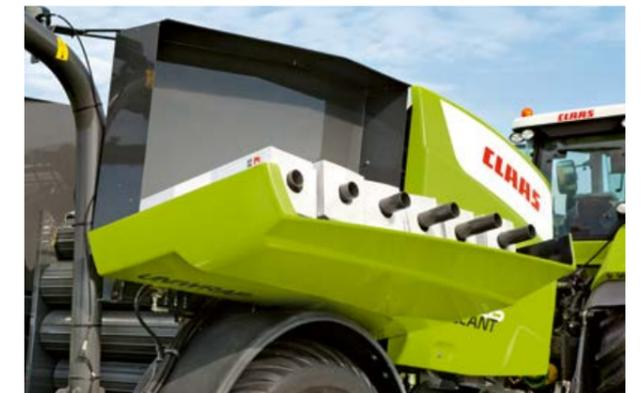
auf den Richtung Presskammer geneigten Wickeltisch. Dort wird der Ballen schließlich zwischen viele groß dimensionierte Stützrollen geführt.
