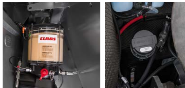
Hydrauliikkaöljyn täyttöaukot ovat konepeiton alla ja säilyvät puhtaina. Öljyn määrä voidaan tarkistaa hyvin näkyvissä olevasta tarkistusikkunasta.
