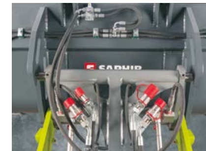
Etuosassa on paineeton paluuliitin sekä vuotoöljyn lisäliitin työvarusteen käytettävissä (644 / 537)
