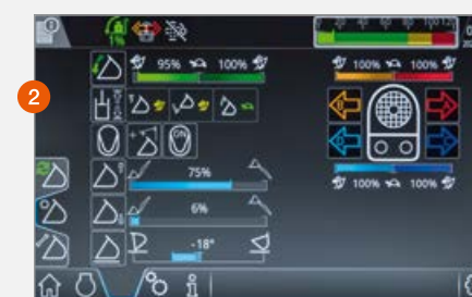
Nosto- ja laskukorkeuden rajoitukset näytetään 9 tuuman kosketusnäytöllä.
