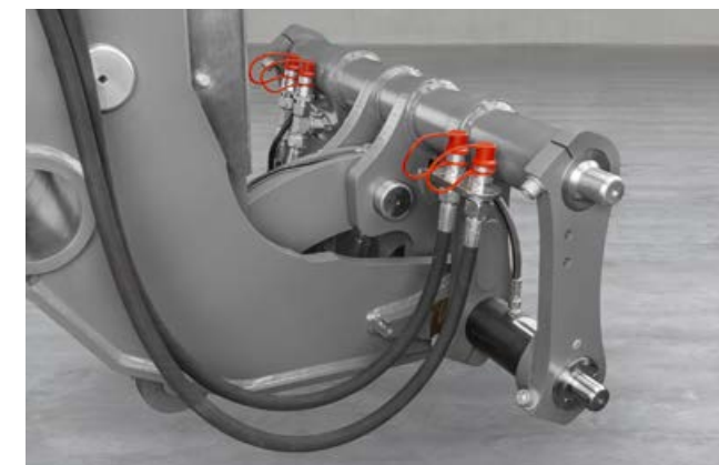
Eteen ja taakse on saatavissa hydraulikan lisäpiirejä.
