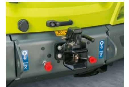
TORION 956 SINUS malliin on lisävarusteena saatavissa paineeton paluuliitin taakse
