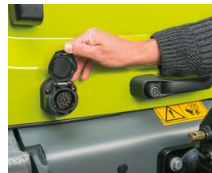
13-napainen pistorasia koneen takaosassa perävaunukäyttöä varten
