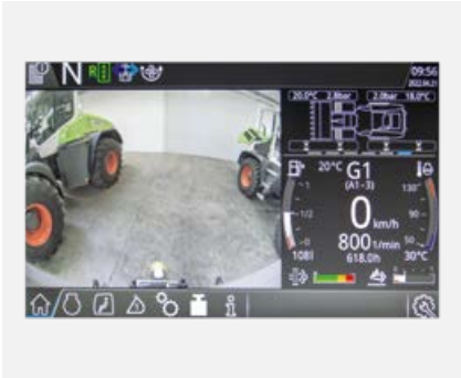
Peruutuskamera kytkeytyy automaattisesti päälle, kun peruutusvaihte kytketään päälle.
