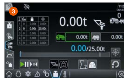
Vaakajärjestelmä mittaa ja dokumentoi tarkasti päi- vittäiset kuormatut määrät.
