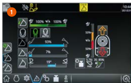
Nosto- ja laskukorkeuden rajoitin tallentaa ihanteelli- sen korkeuden maan pinnasta sekä kaatokorkeu- den.
