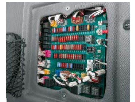
Elektroniikka on koottu yhteen ja siihen käsiksi pääsy on hyvä.
