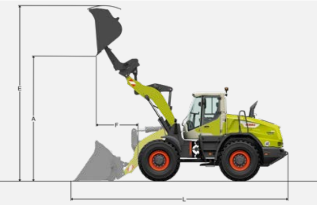
TORION 1611 P-1285. Z-kinematiikalla, työvarusteen pikakytkenällä ja korkealta kippaavalla kauhalla.
