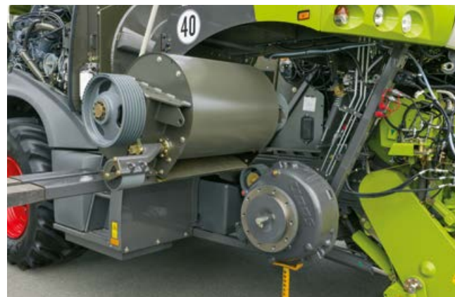
Helpompi kiihdytyskelan irrotus ja asennus
