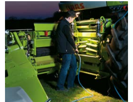
QUICK ACCESS mahdollistaa silppurikoneiston tarkistuksen muutamassa minuutissa.
