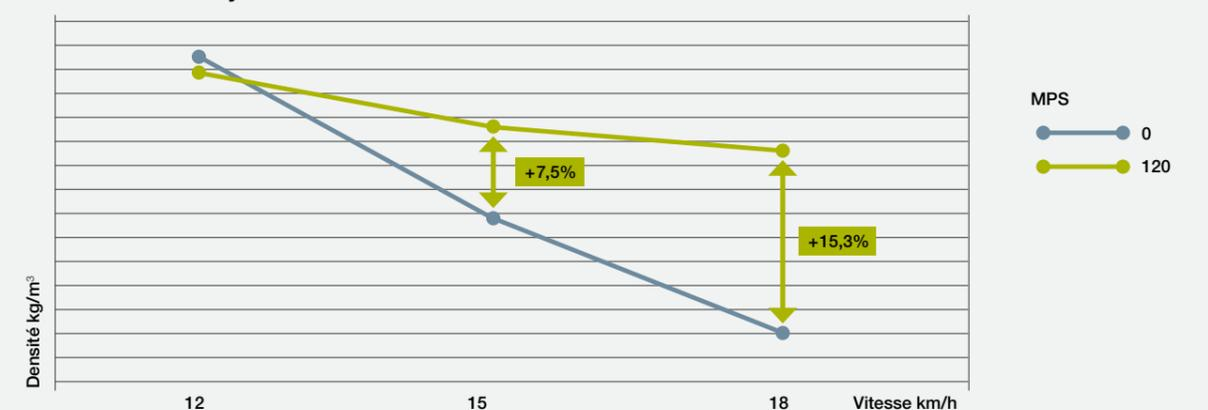
A 12 km/h, même densité avec ou sans MPS PLUS. Avec MPS PLUS à 120 bars, la ROLLANT 455 UNIWRAP conserve son niveau de densité même à grande vitesse. Jusqu'à 15,3 % de densité en plus avec 120 bars sur le MPS PLUS par rapport à la formation de balles sans MPS PLUS.
