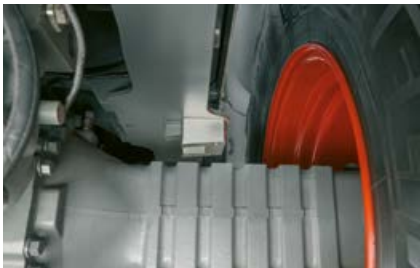
Pour permettre l'utilisation de pneus particulièrement hauts dans l'agriculture, la course pendulaire de l'essieu arrière peut être limitée.
