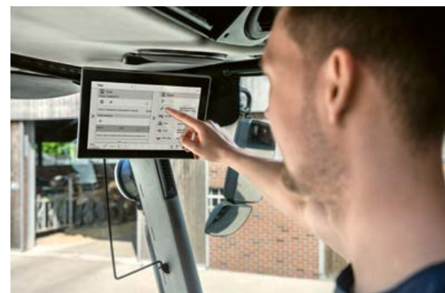
S CEMIS 1200 mohou být vystaveny a spracovány všechny zakázky přímo ve stroji.
