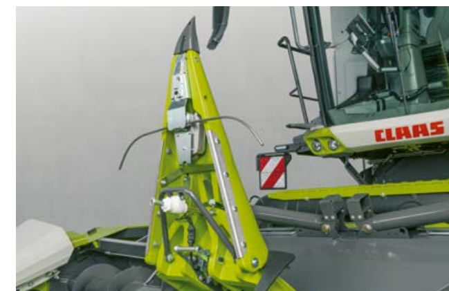
Dva prutové hmatáče snímají každý svůj řádek kukuřice.
