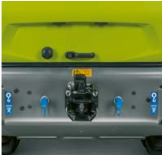
Deux coupleurs rapides hydrauliques supplémentaires à l'arrière.
