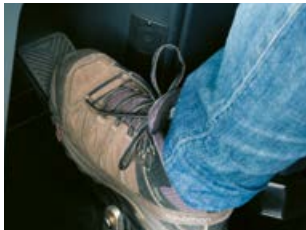
Pédale de frein avec fonction d'approche
