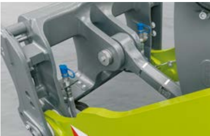
Tout est préparé pour deux autres coupleurs hydrauliques.
