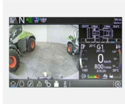
La caméra de recul s'enclenche automatiquement lorsque vous engagez la marche arrière.
