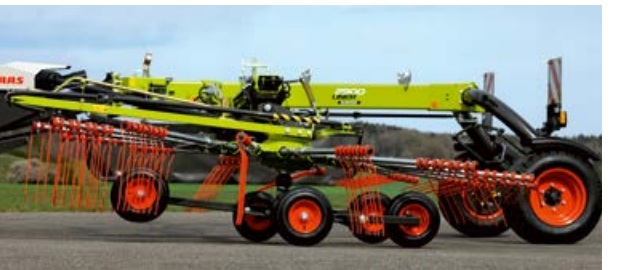
Ефект JET: під час підймання або опускання ротор поводить як літак під час злету або посадки.
