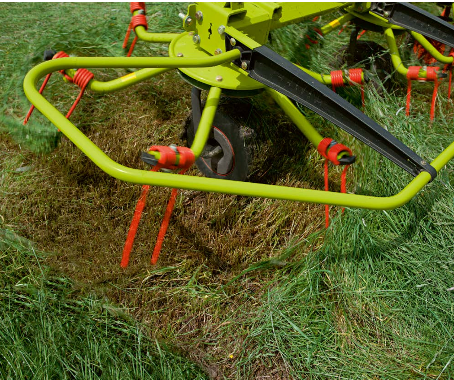
Trabajo de rastrillado limpio: La recogida de material tiene lugar en porciones pequeñas.
