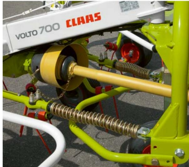
Avancement stable de la faneuse grâce au dispositif CKL de CLAAS.
