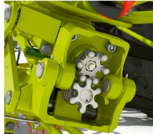
Transmission de puissance : le système d'entraînement à doigts PERMALINK.
