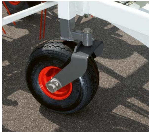
Adaptation optimale au sol grâce à la roue de jauge en option.
