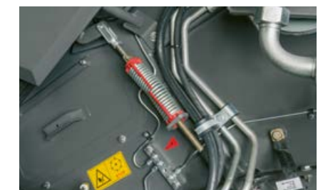
Visi eļļošanas punkti ir sagrupēti centrālās eļļošanas blokos un ir skaidri marķēti.
