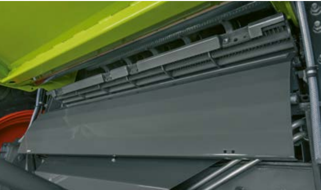
Kuļkurvja segmentu var viegli izvilkt pa akmeņu slazdu.
