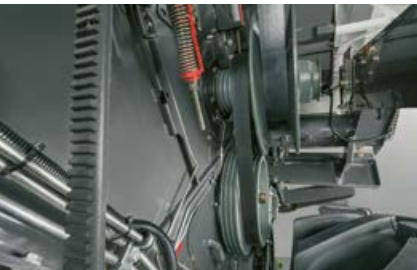
Kulšanas trumuļa piedziņa ar diviem griešanās ātruma diapazoniem, kurus var viegli konfigurēt.
