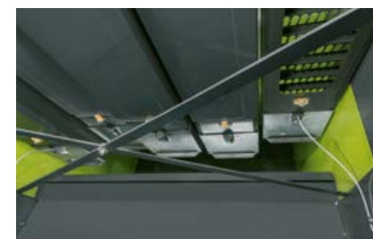
Salmu kratītāju galos ir apkopes atveres, kurām var ātri piekļūt, neizmantojot instrumentus.
