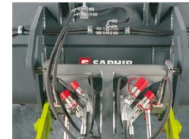
Sprijeđa, nestlačeni povratni vod i dodatni vod za istjecanje ulja s priključkom na nosaču alata. (644 / 537)
