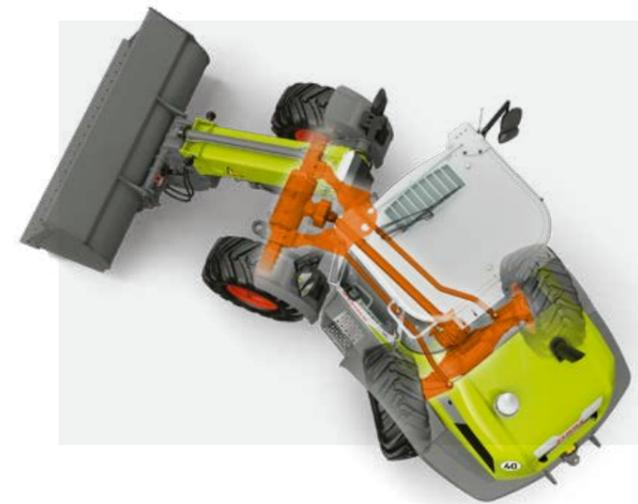
Zahvaljujući visokom kutu njihanja, stojite sigurno čak i kada se utovarivač na kotačima okreće bočno na neravnom terenu. TORION 738 T SINUS zakreće se 8° u svaku stranu u pregibnom njihajućem zglobu.
