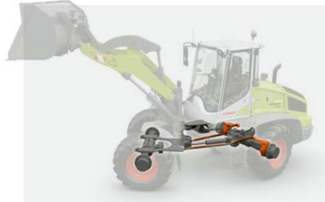
TORION SINUS je razvijen upravo za takve zadatke. Ovaj stroj ne upravlja samo preko pregibnog zgloba u sredini, već i preko stražnje osovine. Dvije letve upravljača spajaju prednja kola sa stražnjim osovinskim rukavcima. Čim savijete utovarivač preko upravljača, stražnja osovina sinkrono sudjeluje u upravljanju.
