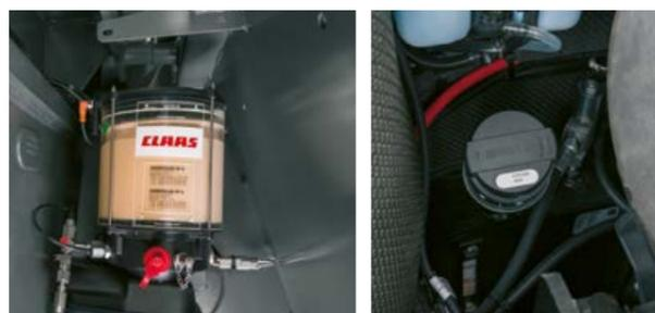
Otvor za punjenje hidrauličkog ulja nalazi se ispod poklopca motora u čistom prostoru. Razina ulja može se odmah očitati kroz jasno vidljivo kontrolno staklo.
