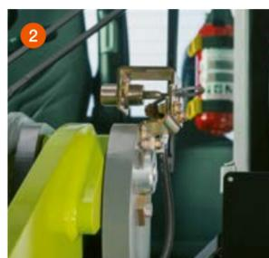
Povratak lopate (1) i ograničenje visine dizanja (2) mogu se mehanički podesiti zasebno za svaki priključak.
