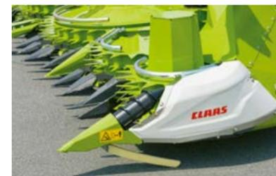
Punta de maíz tumbado accionada hidráulicamente.
