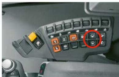
Un interruptor para la totalidad del proceso de pliegue.
