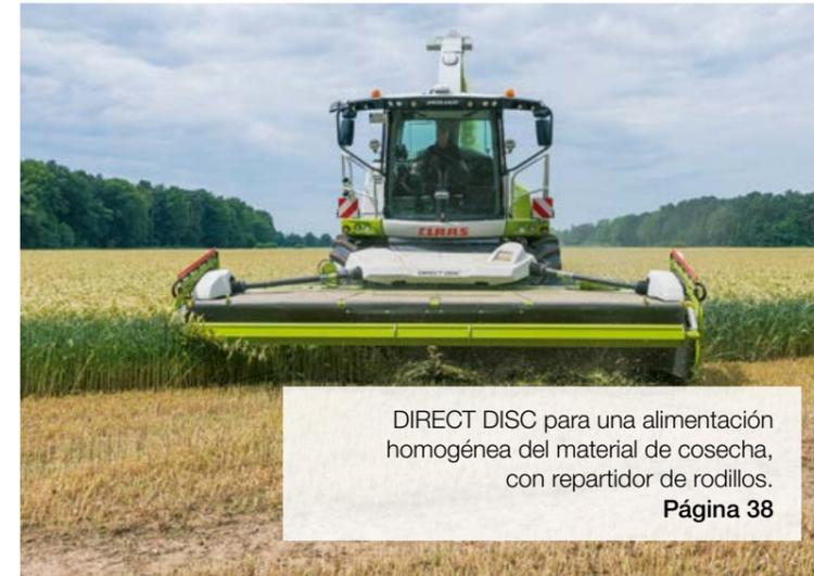
DIRECT DISC para una alimentación homogénea del material de cosecha, con repartidor de rodillos.
