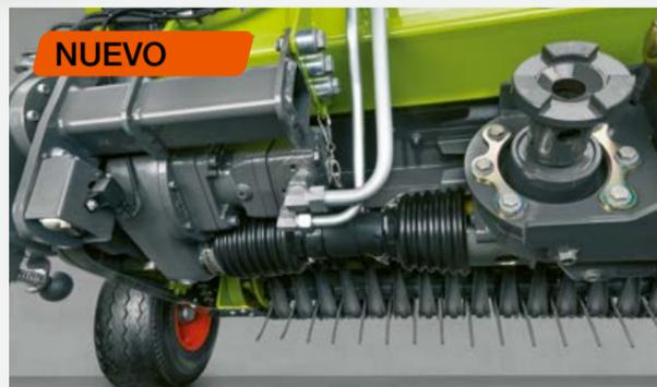
Bastidor pivotante para PICK UP 380 y 300.
