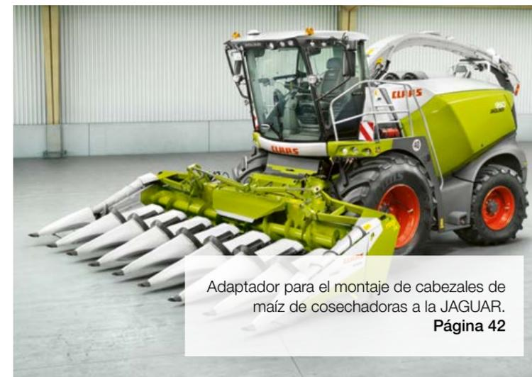
Adaptador para el montaje de cabezales de maíz de cosechadoras a la JAGUAR.
