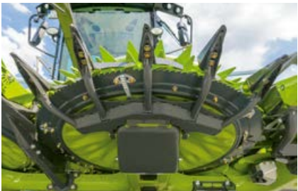
Pointes et racleurs robustes sous le disque de coupe pour un travail propre.
