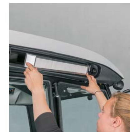
Filtrul de aer din cabină este ușor de accesat din exterior pentru a fi curățat și menține aerul din cabină proaspăt în permanență.
