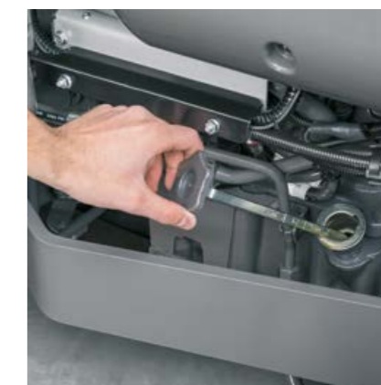
Nivelul uleiului este verificat și completat cu capota închisă, pe partea dreaptă a modelului ELIOS 200.
