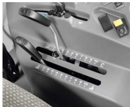
Comenzile mecanice pentru tirantul spate sunt poziționate ergonomic în partea dreaptă a scaunului operatorului.
