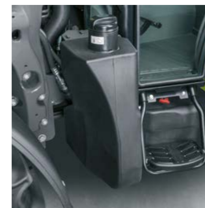
Rezervorul de motorină de 95 l și rezervorul de uree de 10 l oferă o autonomie suficientă chiar și în zilele de lucru lungi și intense.
