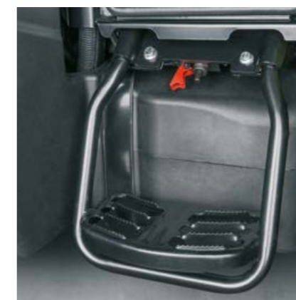
Comutatorul de deconectare a bateriei este situat convenabil pe treapta de acces stânga (cu excepția modelului ELIOS 210)
