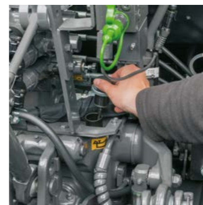
Puteți verifica cu ușurință în spate nivelul uleiului de transmisie și pentru sistemul hidraulic.
