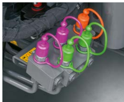
Până la patru conexiuni hidraulice și un circuit de retur cu debit liber sunt disponibile în partea dreaptă față a cabinei.
