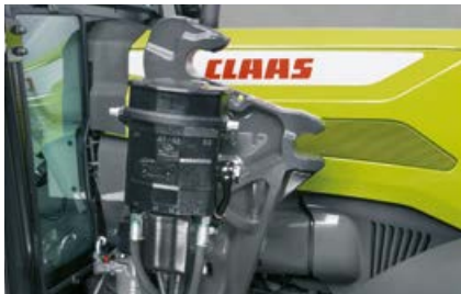
FITLOCKi süsteem kiireks kinnitamiseks ja eemaldamiseks ning MACHI kiirliitmik elektri ja hüdraulika ühendamiseks.
