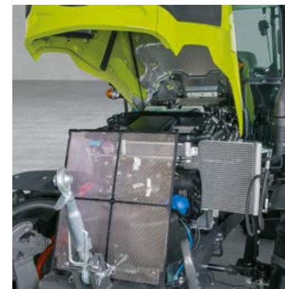
Jahuti saate hetkega välja tõmmata ning jahutivõre kontrollimiseks ja puhastamiseks eemaldada.
