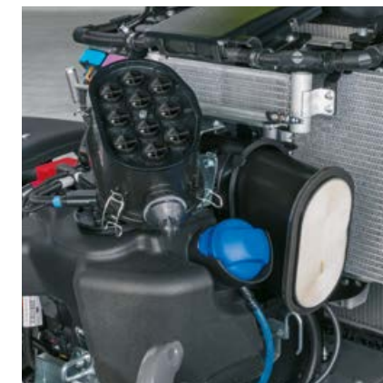
PowerCore®-i õhufilter, mis asub esiosas kapoti all, on kergesti ligipääsetav ja pikendab puhastusintervalli.
