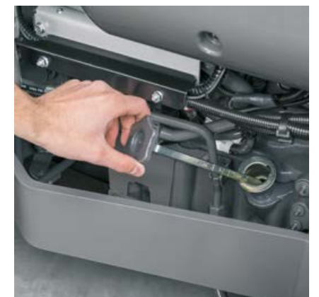
Õlitaset kontrollitakse ja õli lisatakse kinnise kapotiga AXOS 200 paremalt küljelt.
