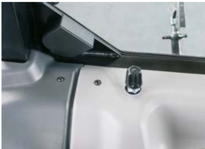
Mehaanilise hüdrojagaja nr 3 maksimaalset voolukiirust saab piirata kabiinis oleva käepidemega.
