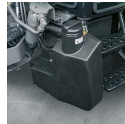
105 l diislikütuse paak ja 10 l uureapaak tagavad pikaks ning intensiivseks tööpäevaks piisava varu.
