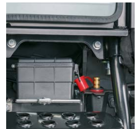
AXOS 200 hõlbustab Teie igapäevaelu paljude nutikate lahendustega (näiteks kergesti ligipääsetavad akuklemmid kabiini paremal küljel).
