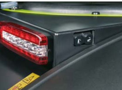
Parempoolsel juhtpaneelil saate mugavalt seadistada veojõukontrolli, langetuskiirust ja tõstekõrguse piirangut.
