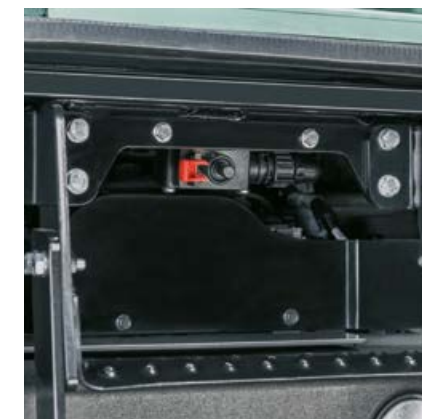
Aku lahklüüti on mugavalt paigutatud vasakpoolse trepi juurde.
