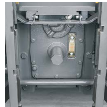
Käigukasti ja hüdraulika õlitaset saate kontrollida läbi vaateklaasi, mis asub tagumise jõuvõtuvõlli otsa kõrval.
