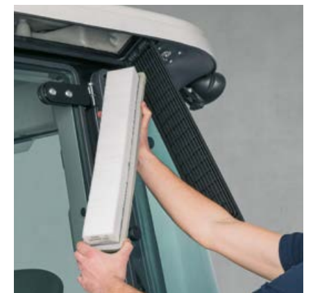
Kabiini õhufilter, mida pääsete väljast lihtsalt puhastama, hoiab kabiinis õhu alati värskes.
