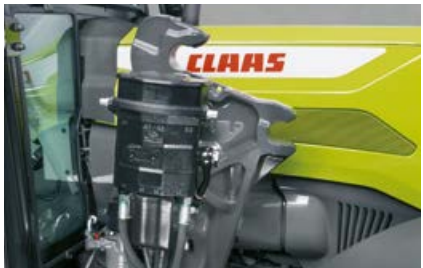
FITLOCK system til hurtig på- / afmontering og MACH hurtigkobling til elektriske og hydrauliske forbindelser
