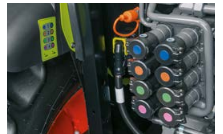
Tilslutningerne bagpå er nemme at afkode takket være deres farvekoder og mærkater.
