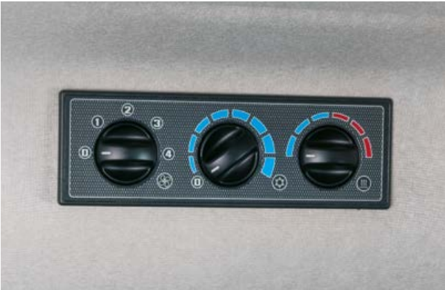
Det er nemt at komme til betjeningen af ventilationsanlægget i loftbeklædningens højre side.
