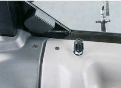
Det er muligt at begrænse den maksimale flowmængde for den mekaniske styreenhed nr. 3 via et greb i kabinen.
