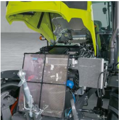
Køleren er super nem at trække ud, og kølersien er nem at trække ud til kontrol og rengøring.
