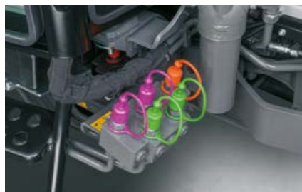
Foran er der op til fire hydrauliske tilslutninger og et frit returløb.
