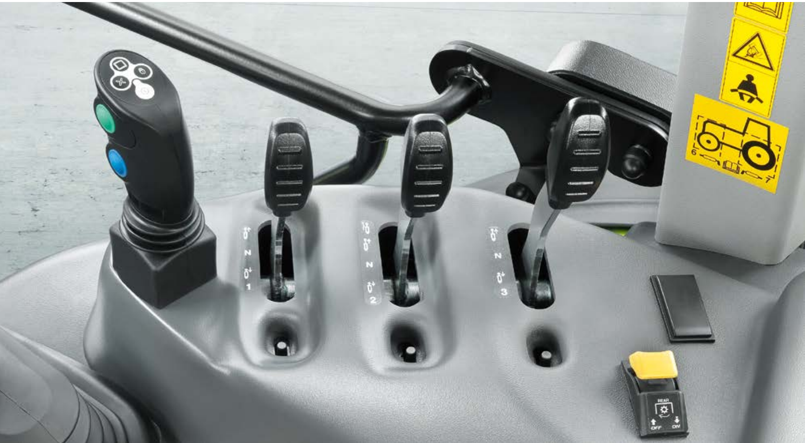
Mekaanisen, hallintaventtiilin nro 3 enimmäisvirtausmäärää voidaan käden käänteessä rajoittaa ohjaamosta.
