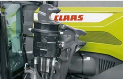
FITLOCK järjestelmä sallii nopeat kytkennät sekä irrotukset ja MACH pikaliittimet sähkö- ja hydraulikkaliitoksia varten.
