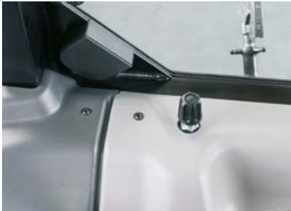
Mekaanisen, hallintaventtiilin nro 3 enimmäisvirtausmäärää voidaan käden käänteessä rajoittaa ohjaamosta.
