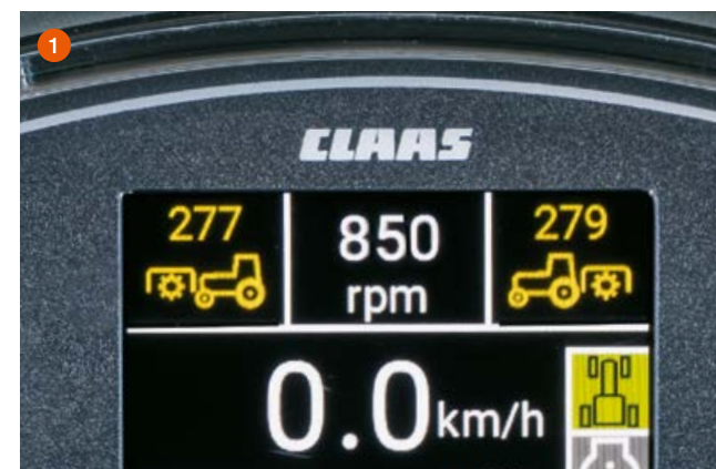
1 Etu- ja takavoimanoton digitaalisen kierrosnopeusnäytön ansiosta voit aina käyttää sopivaa kierrosnopeutta.
