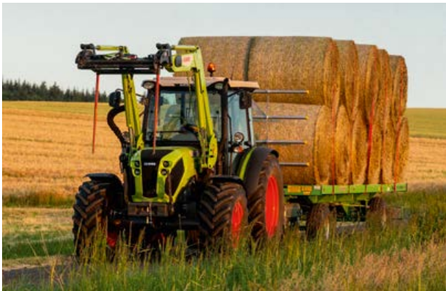
Valmiina olevien kiinnityskohtien ansiosta etukuormain on helppo asentaa myös myöhemmin.
