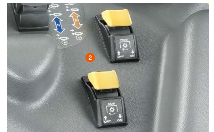
2 Etu- ja takavoimanoton päälle kytkentä tehdään helposti napin painalluksella.
