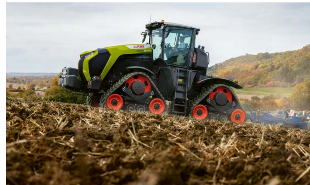
◀ Jousituskonsepti – alkaen jousituksella varustetusta telalustasta, ohjaamon 4-pistejousituksen kautta, jousitettuun Premium istuimeen – varmistavat XERION'in erityisen hyvän ajomukavuuden.
