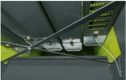
Onderhoudsopeningen aan het einde van de schudders zorgen voor snelle toegang zonder gebruik van gereedschap.
