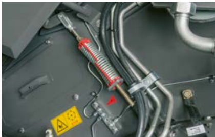
Alle smeerpunten zijn in centrale smeerlijsten gebundeld, die duidelijk gemarkeerd zijn.
