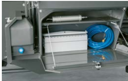
Na de werkzaamheden zorgen 20 liter water en de zeepdispenser ervoor dat u uw handen kunt wassen.
