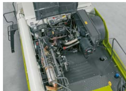
Cummins-motor met AdBlue-uitlaatgasnabehandeling (Stage V)
