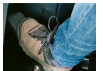
Bremspedal mit Inch-Funktion
