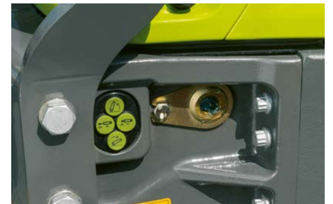
Elektroniniai hidrauliniai skirstytuvai išoriniam priekinio prikabinimo mechanizmo valdymui bei papildomas hidraulinis skirstytuvai.
