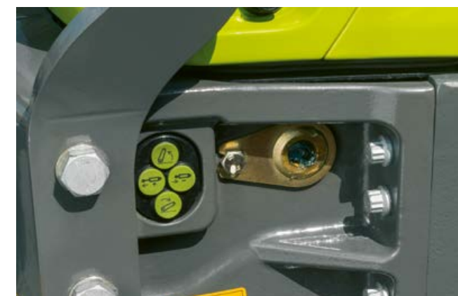
Elektronicky ovládanými rozvaděči může být čelní zvedací závěs a přídavný rozvaděč ovládán také externě.
