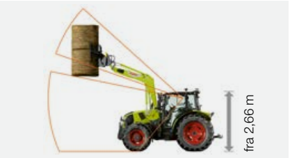
Højtagskabine med glastaglem: Gennemkørselshøjde fra 2,66 m.
