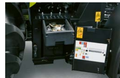
I opstillingen i højre side er batteriet, værktøjskassen og en tryklufttilslutning anbragt let tilgængeligt.
