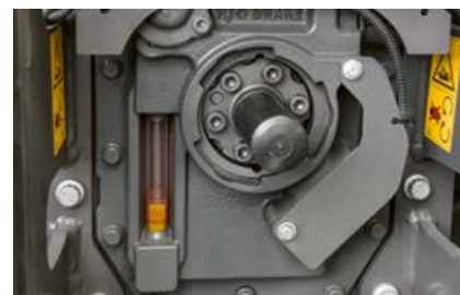
Oliestanden i transmissionerne og hydraulikken kontrolleres med et kontrolglas ved siden af PTO-akslen.
