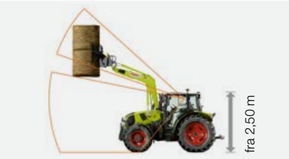
Lavtagskabine med glastaglem: Gennemkørselshøjde fra 2,50 m.
