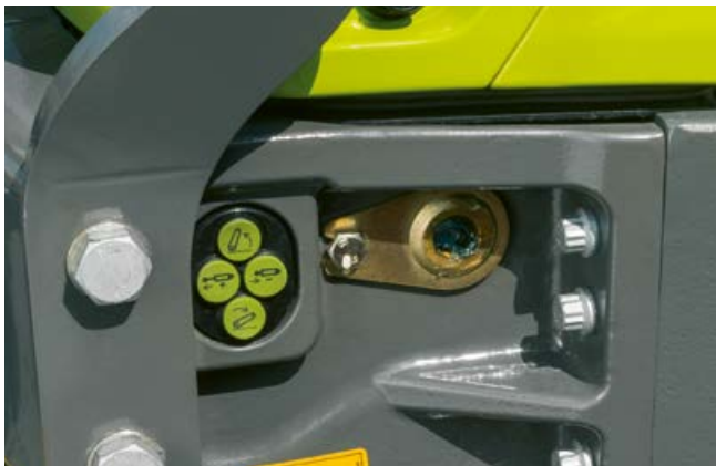
Frontliften og det yderligere olieudtag kan også betjenes eksternt med elektroniske olieudtag.
