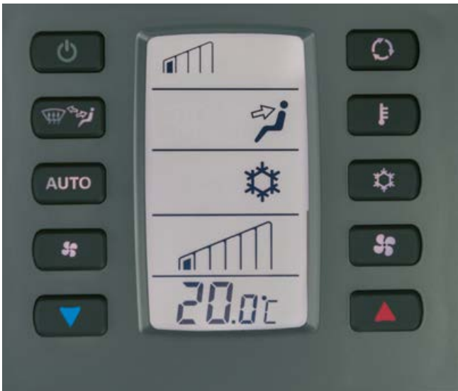
Ud over den manuelle klimastyring fås et automatisk klimaanlæg, som fordeler luftstrømmen behageligt i kabinen.
