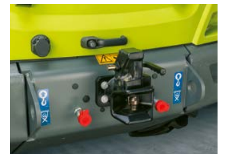
De TORION 956 SINUS met een als optie leverbaar drukloos retour aan de achterzijde.
