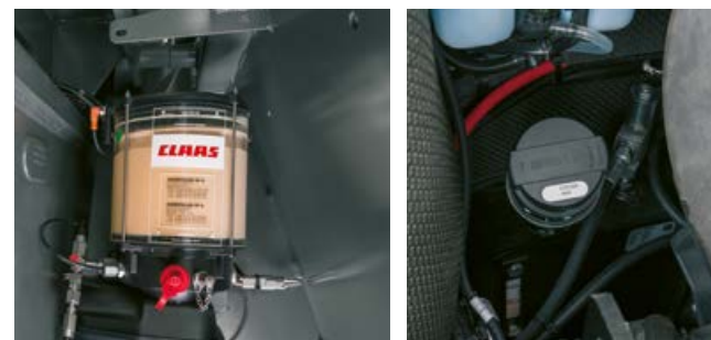
De vulpijp voor hydraulische olie is in een schoon gedeelte onder de motorkap aangebracht. Het oliepeil kan worden afgelezen met behulp van een kijkglas.
