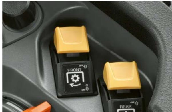
L'innesto automatico della presa di forza può essere regolato in continuo in base all'altezza del sollevatore posteriore. Per farlo basta portare il sollevatore nella posizione desiderata e premere a lungo il pulsante della presa di forza; la posizione d'innesto desiderata viene salvata automaticamente.
