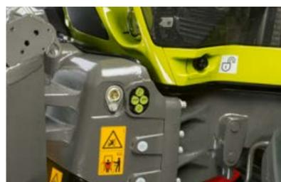
Comando esterno per sollevatore anteriore e un distributore (a seconda della dotazione).
