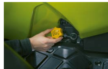
Met een gesloten motorkap kan het oliepeil worden gecontroleerd en olie worden bijgevoerd.
