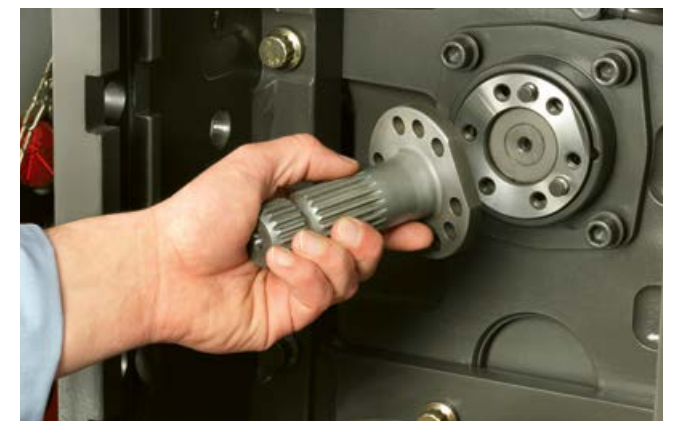
Eenvoudig verwisselen van de aftakasstomp.
