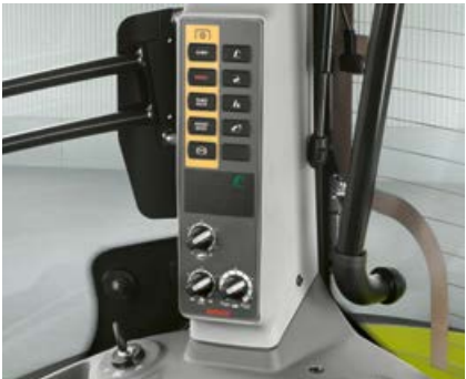
Aftakassnelheden en elektronisch geregelde hefinrichting worden op de B-stijl ingesteld.
