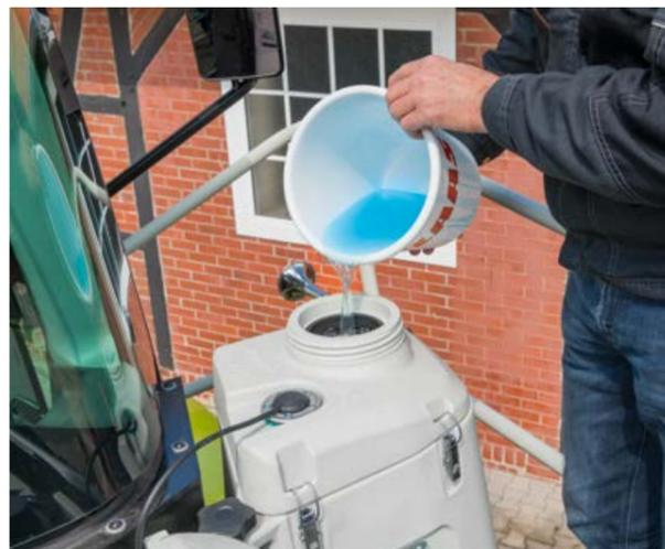
Enchimento do tanque de aditivo de silagem
