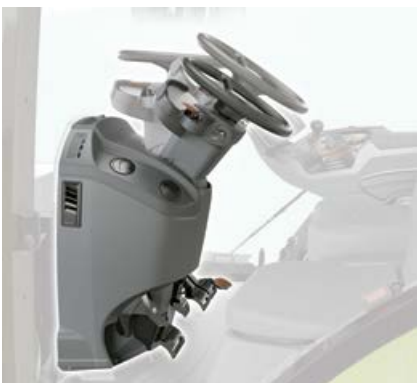
Instrumentbordet er anbragt på den fleksibelt indstillelige ratstamme
