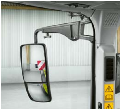
Ud over det store spejl er et vidvinkelspejl, der giver større sikkerhed ved vejkørsel, standard.
