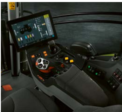
Når kørelyset er tændt, er alle betjenings-elementer og symbolerne i alle kontakterne oplyst. I CEBIS kan man også vælge en mørkere farveskala
