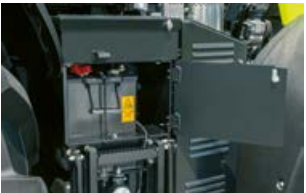
Batteriet er placeret let tilgængeligt i højre stige.
