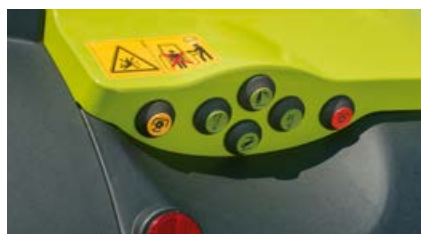
Eksterne betjeningslementer for baglift, PTO-aksel og et valgfrit olieudtag (kun CEBIS).
