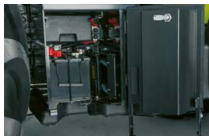
I højre side af stigen findes batteriet og et opbevaringsrum til værktøj – let tilgængeligt.
