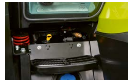
Der er monteret en trykluftslutning til venstre i stigen.
