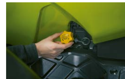
Oliestandskontrol og efterfyldning er muligt med motorhjelmen lukket.
