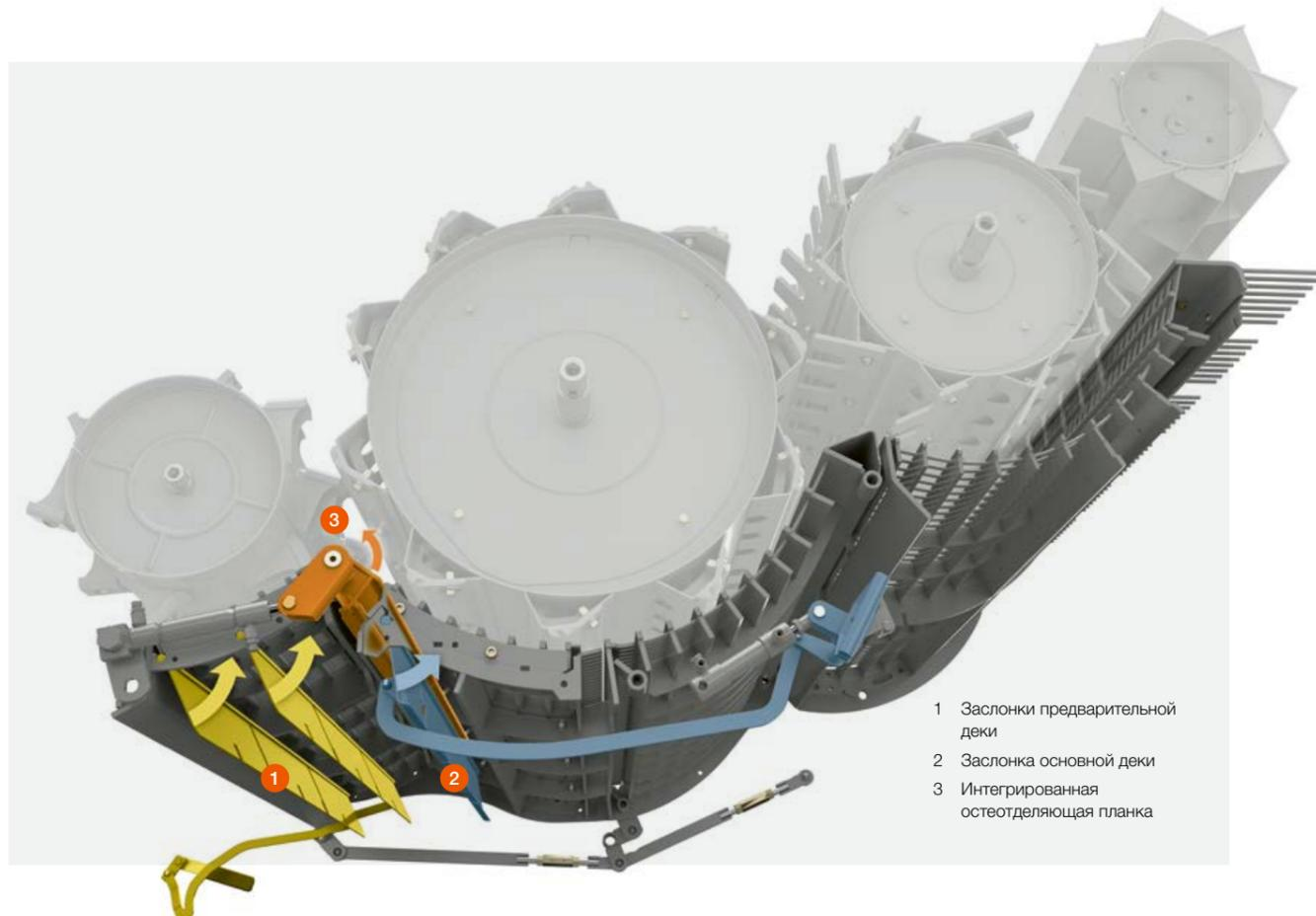
**Параллельная регулировка дек.**
