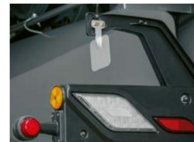
Датчик автомат. регулировки направления разбрасывания.
