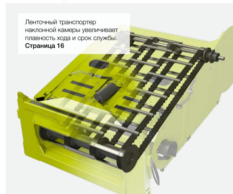
Ленточный транспортер наклонной камеры увеличивает плавность хода и срок службы.
