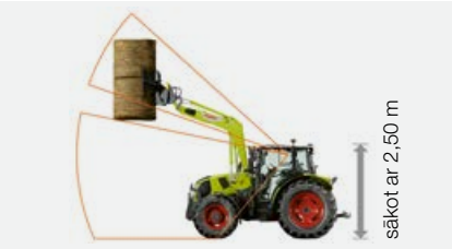
Zema profila kabīne ar stiklotu jumta lūku: augstums no zemes līdz jumtam ir 2,50 m.
