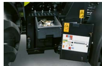
Lai varētu ērti piekļūt, akumulators, instrumentu kaste un saspiesta gaisa savienojums atrodas pie kāpšļiem, labajā pusē.
