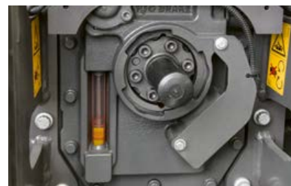
Transmisijas un hidrauliskās eļļas līmeni var pārbaudīt pa pārbaudes stikliņu, kas atrodas blakus jūgvārpstai.
