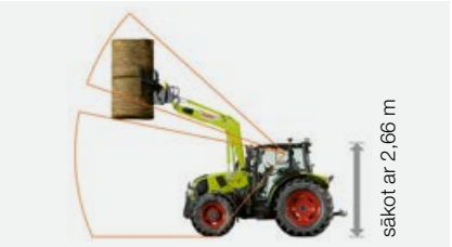
Augsta profila kabīne ar stiklotu jumta lūku: augstums no zemes līdz jumtam ir 2,66 m.
