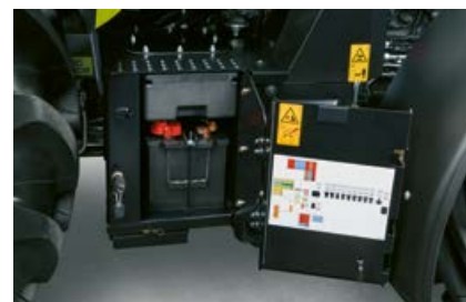
Lai varētu ērti piekļūt, akumulators, instrumentu kaste un saspiesta gaisa savienojums atrodas pie kāpšļiem, labajā pusē.
