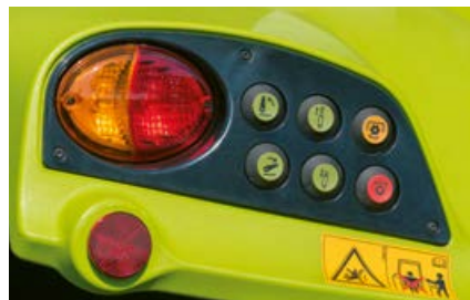
De achterhefinrichting, het elektronisch regelventiel en de aftakas kunnen op beide spatborden worden bediend. Op het linker spatbord is een houder voor vier trekstangkogels aangebracht.
