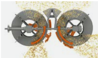
Radialspreder for effektiv halmbehandling med lavt effektbehov.
