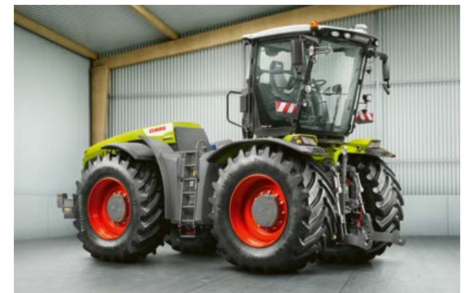
TRAC VC:ssä on markkinoiden mukavin taakseajovarustus. Ohjaamo voidaan kääntää 180° alle puolessa minuutissa.
