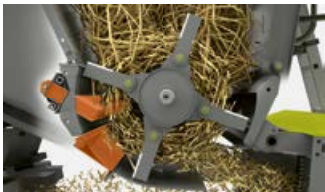
Faste knive og svingbart svøb i SPECIAL CUT snitteren.
