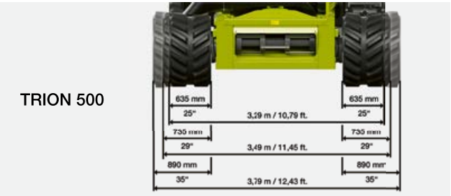
Med 635-mm bæltet fylder TRION ikke meget på vejen og øger således din mobilitet.
