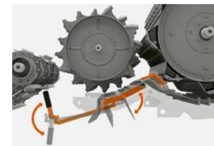
Forbroklapper kørner og fjerner avner.
