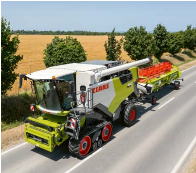
Alle TERRA TRAC bælte er godkendt til landvejskørsel op til 30 km/t og er mere behagelige at køre end hjulmaskinerne.
