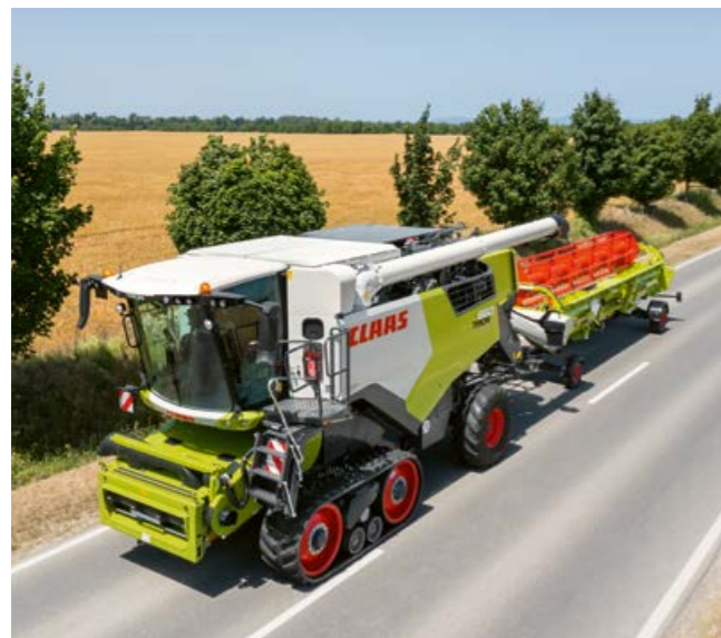
Kaikkia TERRA TRAC teloja voidaan käyttää jopa 30 km/h maantiellä ja ajaminen on mukavampaa kuin pyöräkonella.
