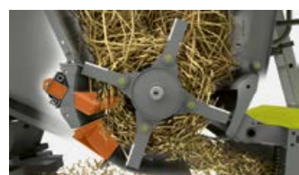
SPECIAL CUT sirppurin vastaterä ja käännettävä pohjaosa.
