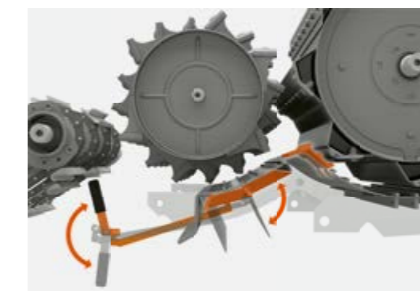
Esipuintikelan hankauslevyt erottavat viljan ja poistavat siitä vihneet.
