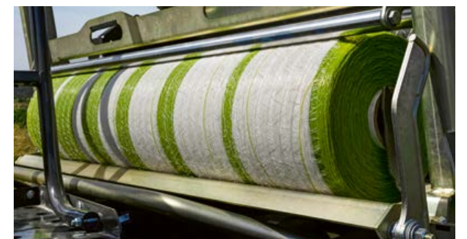
VARIANT 500 sērijā jaunā tīklā iesiešanas sistēma atrodas 25 cm zemāk, lai varētu viegli notīrīt tīkla rulli, kas atrodas zem tīkla bremzes.
