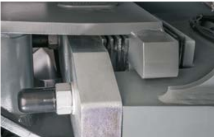
Pasvyrančio posūkio lanksto guminiai amortizuojantys elementai padidina komfortą operatoriui.
