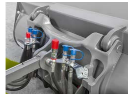
Visos jungtys yra lengvai pasiekiamos ir gerai apsaugotos ant priedų laikiklio (956)
