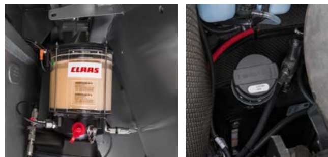
Hidraulinės alyvos pripylimo anga įrengta švarioje vietoje, po variklio gaubtu. Alyvos lygį galima lengvai ir tiesiogiai patikrinti pro aiškiai matomą tikrinimo langelį.
