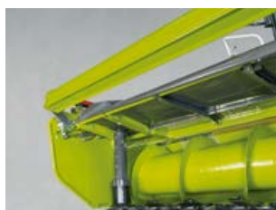
Prispaudimo volai labai tolygiam augalų masės tiekimui.
