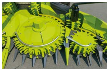
Saugus augalų masės transportavimas specialiais kanalais.
