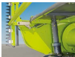
Reguliuojami prispaudimo įrenginiai, taip pat galima pasirinkti hidraulinį.
