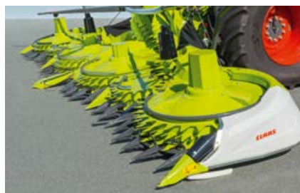
Ypatingai plokščia konstrukcija skirta labai mažam pjovimo aukščiui.
