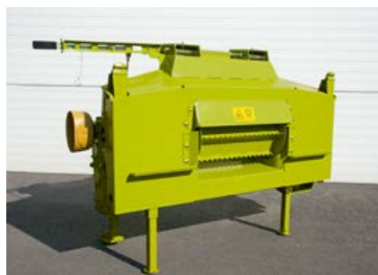
Adapteris javų kombainui skirtai kukurūzų skabyklei.
