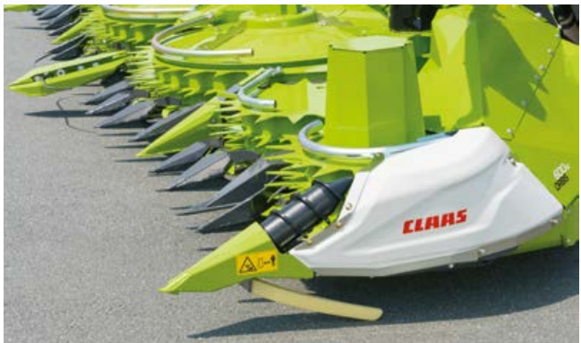
Jeigu reikia, gali būti sumontuotos hidraulinė pavarą turinčios sraigės pagulusiems kukurūzams.
