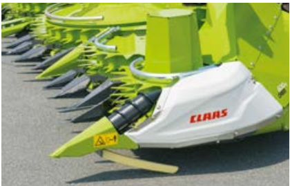
Skirtuvas pagulsiams kukurūzams su hidrauline pavara.
