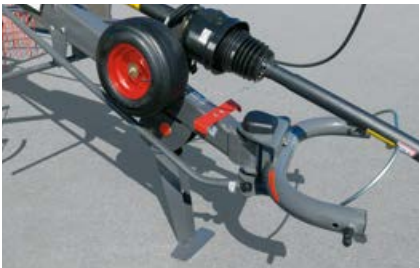
Tillkoppling med bygelram och tvärpending möjliggör snäva svängar på upp till 80°.
