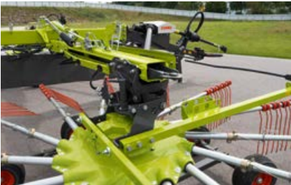
Inställning av räfshöjd. Hydraulisk inställning, en sida i taget. Val av sida med en wire.
