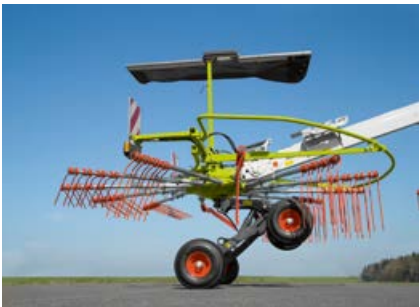
Hög lyfthöjd för att kunna köra över strängar på vändtegar: upp till 50 cm på LINER 700 TWIN.
