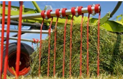
Räfspinnar för ensilage för skonsamhet mot materialet.
