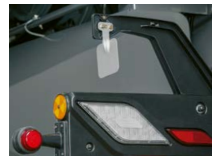
Sensors automātiskai kļiedšanas virziena regulēšanai.
