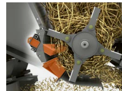
Stacionārais nazis un pagriežamais berzes elements SPECIAL CUT smalcinātājā.
